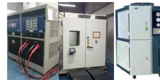
AV900动力循环测试 + WeissVotesh步入式环境箱 + 电池包热管理
