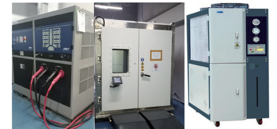
AV900动力循环测试 + WeissVotesch步入式环境箱 + 电池包热管理
